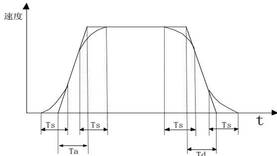
设置规则:  $\frac{T_a}{2} \geq T_s, \frac{T_d}{2} \geq T_s$
