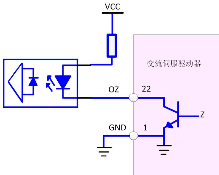
● VCC 最大电压 30V，输出电流最大 50mA。VCC peak voltage 30 V, output current maximum 50mA
