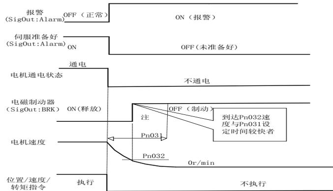
注 1: 使用电磁制动功能时, 伺服断使能方式 Pn005 必须设置为 2 Note 1: when using electromagnetic brake function, servo broken way can make Pn005 must be set to 2
